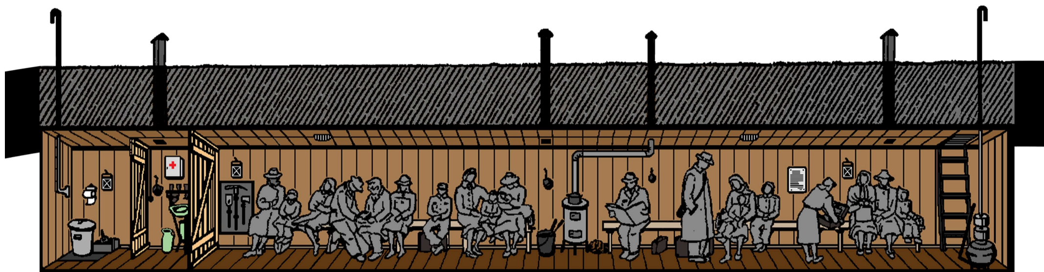
nahoře: řez protiletectkým krytem odlišné konstrukce s vnitřním vybavením (upravená dobová ilustrace)
